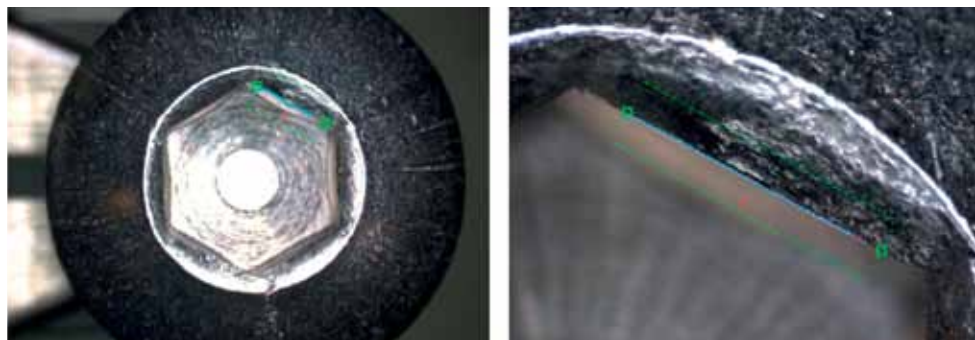
Bild 1. Kantenerkennung bei kleiner und großer Zoomstufe, links: schlecht, rechts: gut
